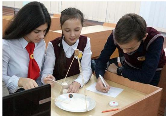
2 группа: создает и изучает пружинный маятник с помощью различных пружин и шариков различной массы
